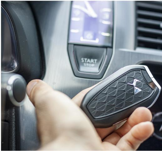
*Täter können mit einem Funkstrecken-Verlängerer das Signal des Schlüssels bis zum geparkten Auto verlängern und dem Wagen vorgaukeln, der Schlüssel ist in der Nähe - und schon ist das Auto entsperrt!*
